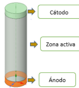
Figura 2. Partes principales de una batería de iones de litio empleadas en el enfoque MSM
