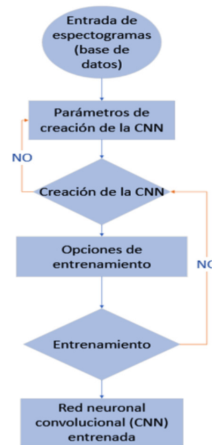
Figura 9. Diagrama de flujo del proceso de entrenamiento de la CNN.
